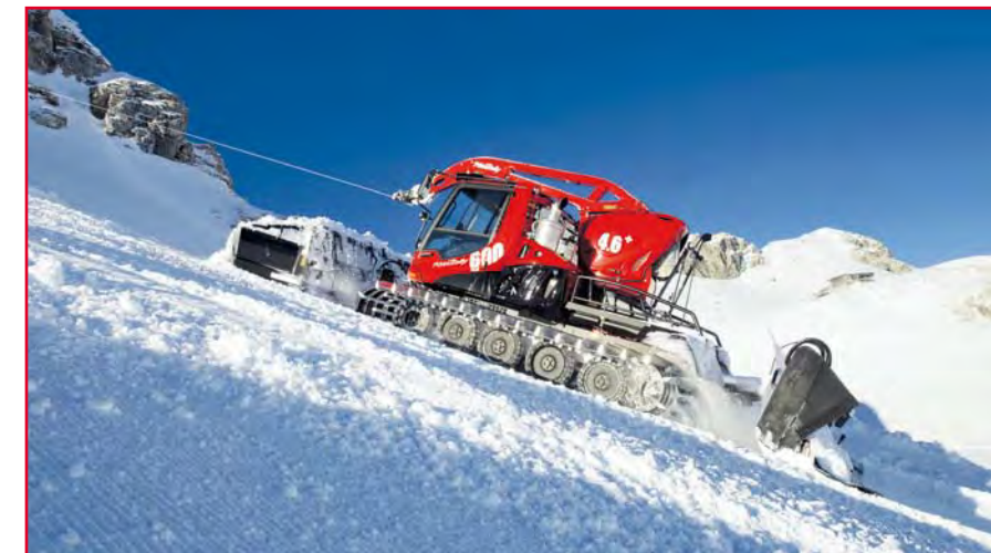
Nový PistenBully 600W Polar – navijakové vozidlo s automaticky spojitým riadením ťažnej sily 4,6 t a 1 400 m dlhým lanom
