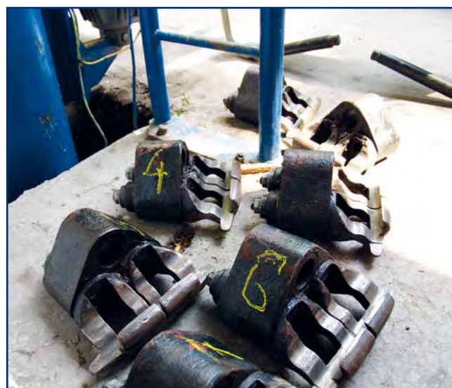
Pri defektoskopii sa kontrolovali aj úchyty sedačkových konštrukcií
