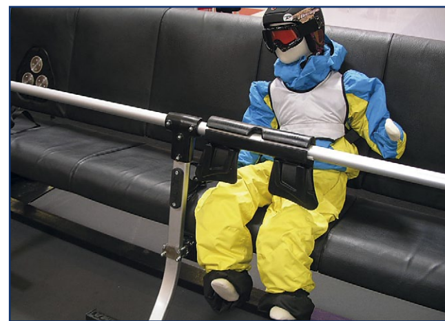
Trojnásobná bezpečnosť pre deti: magnetická vesta, magnetický zámok ochranného rámu, mechanická zábrana
